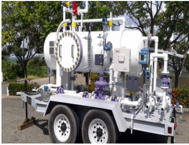
Figura 2. Separador de medición
