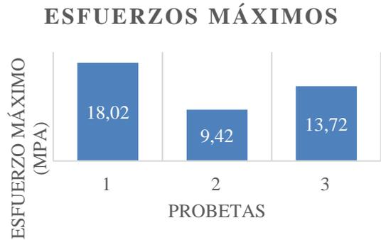
Figura 9. Esfuerzo máximo a flexión
