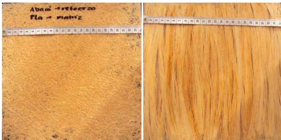
Figura 2.7. Láminas de material compuesto de matriz de PLA reforzada con fibra natural de abacá.
