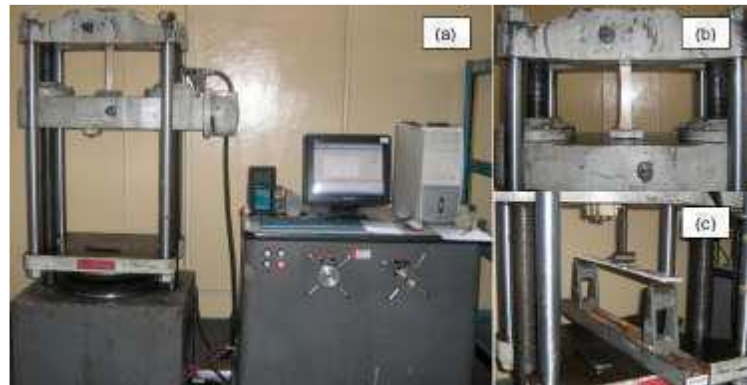
Figura 4.16 (a) Máquina universal de ensayos Tinius Olsen modelo Súper L. (b) Mordazas Cuneiformes. (c) Set de flexión a tres puntos
