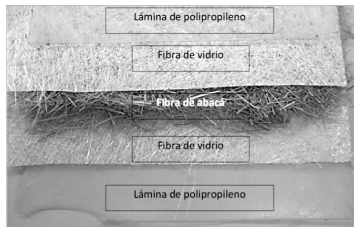
Figura 2.6. Preparación del material compuesto híbrido tipo sánduche.
