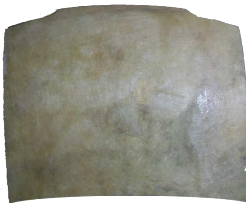
Figura 1.10 Capot fabricado por estratificación manual
