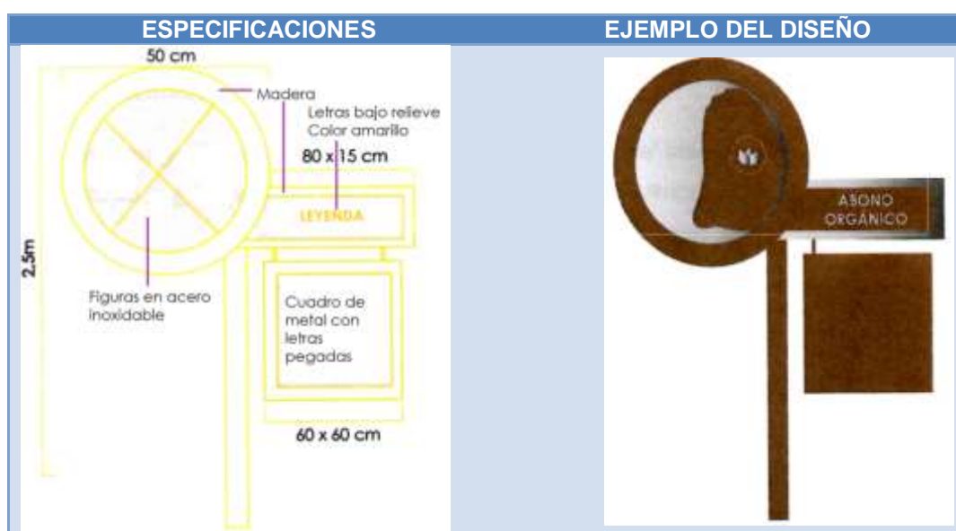
Figura N° 3.12 Especificaciones de la señalética interpretativa
