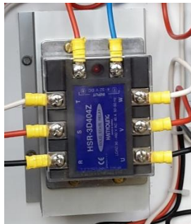
Figura 10. Driver de accionamiento de triac's
