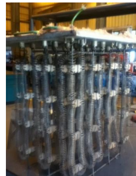
Figura 3. Banco de resistencias calefactoras
