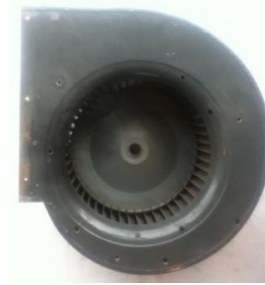
Figura 2. Ventilador centrifugo de álabes curvados hacia adelante
