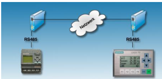
Figura 11. Diagrama esquemático de comunicación PLC con HMI
