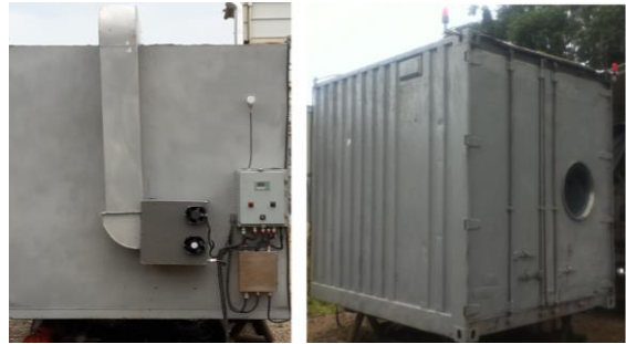
Figura 19. Horno para el secado de motores eléctricos
