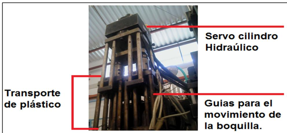
**Figura 2.72. Descripción del servo cilindro y los componentes del cabezal.**
