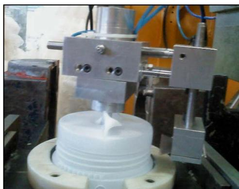
**Figura 2.77. Cortador automático de rebabas.**
