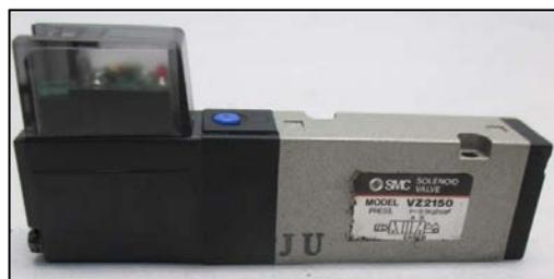
**Figura 2.14. Electroválvula neumática de retorno por muelle.**
