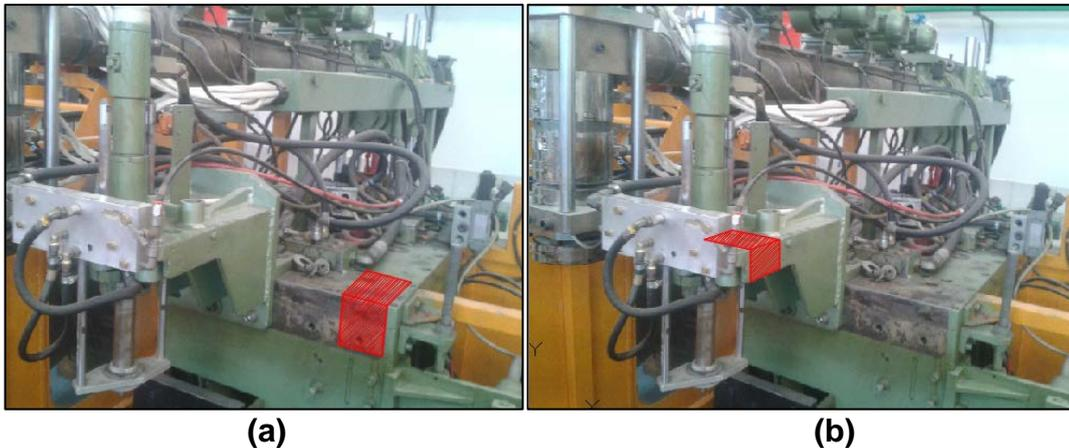
Figura 2.38. Ubicación del Cortador: a) En la extrusora; b) En la base de soplado.
