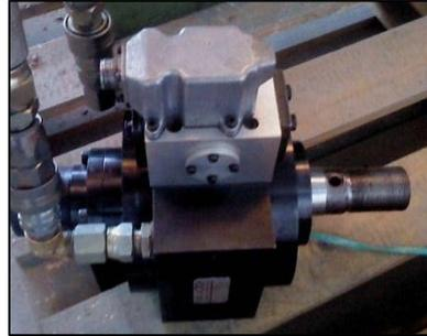
**Figura 2.6. Servo cilindro hidráulico MOOG.**
