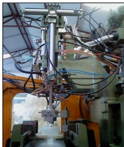
**Figura 2.75. Cortador automático de rebabas en la máquina Magic simple.**
