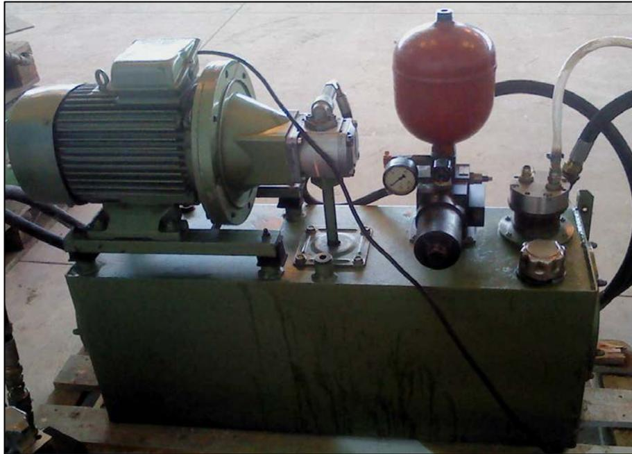
**Figura 2.28. Unidad Hidráulica MAGIC M.P.**
