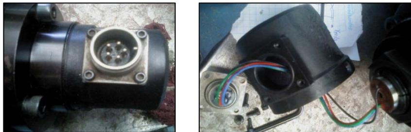
**Figura 2.7. LVDT en el servo cilindro hidráulico.**
