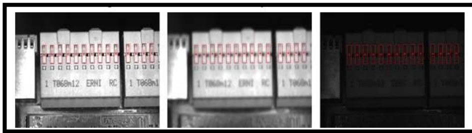
Figura 1.18 Ejemplo de ajuste de patrones de imágenes de contraste bajo
