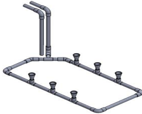
Figura 4. 14. Estructura de la tubería de recirculación.
