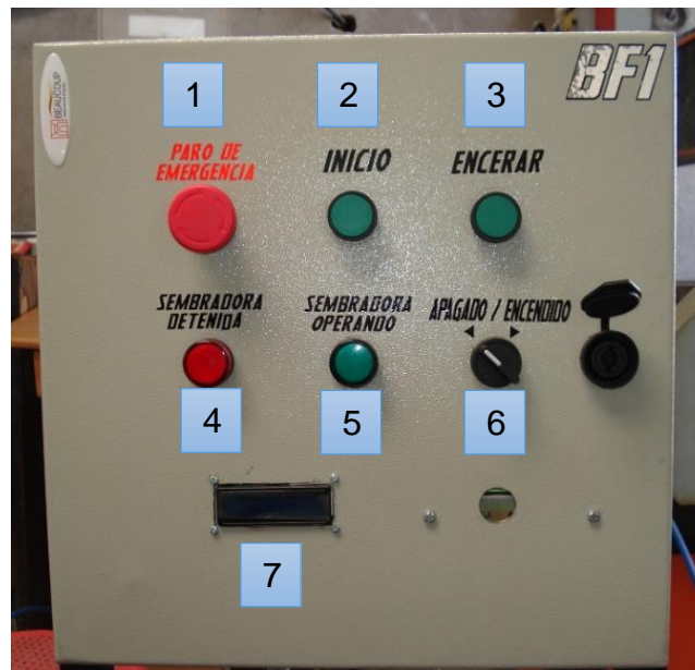
Figura 4.22 Vista frontal del tablero de control de la máquina.
