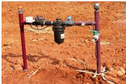
**Figura 2.6. Controlador de riego.**
