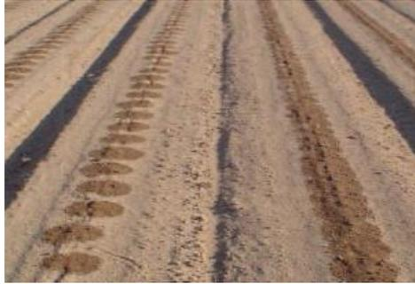
**Figura 2.5. Efecto de la distancia entre emisores a la humectación del suelo.**
