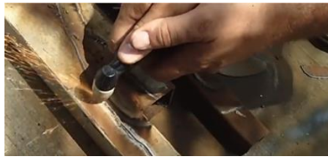
Figura 4. 18 Cortando metal para la base del motor reductor
