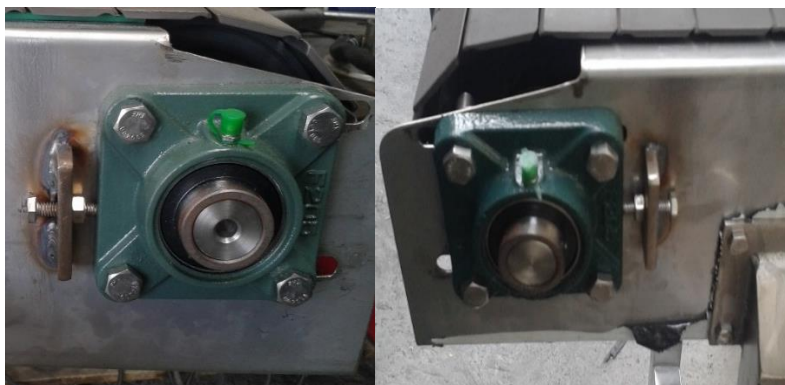
Figura 4. 17 Fijación de las chumaceras F205
