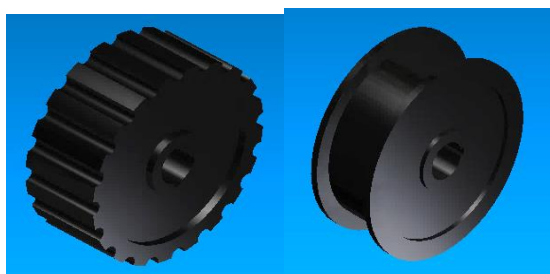
Figura 4. 14 Piñón Acetal y Roldana (Simulado)
