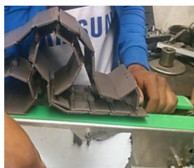
Figura 4. 11 Colocación de la cinta transportadora acetal
