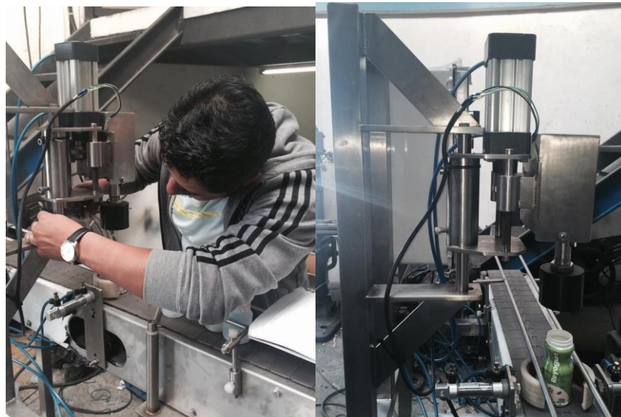
Figura 4. 25 Colocación y verificación de la boquilla de tapado
