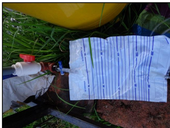
Muestra de biogás después del filtro
