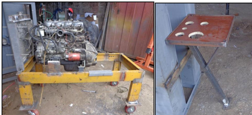
Figura 3. 11. Chasis terminado con su radiador y soporte de instrumentos.
