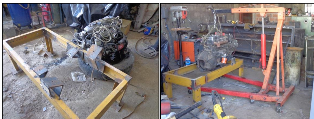
Figura 3. 10. Estructura del chasis con bases para el motor.
