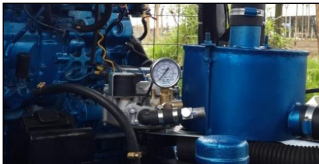
Figura 3. 20. Montaje del bi-fuel al chasis.
