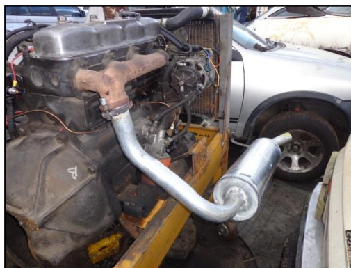
Figura 3. 12. Adaptación del tubo de escape.
