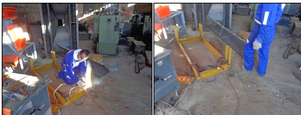
Figura 3. 9. Soldado de las juntas de los materiales del chasis.
