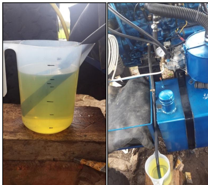
Figura 4. 3. Toma de muestra de consumo de motor dual.
