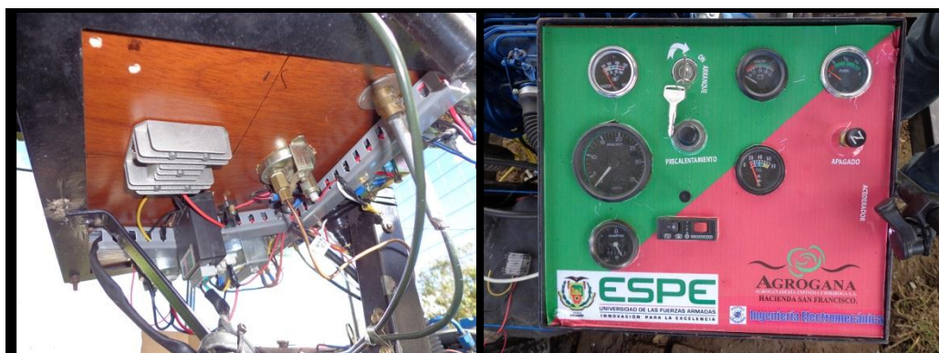
Figura 3. 14. Conexión del tablero de instrumentos.
