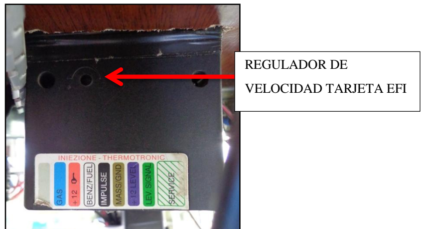
Figura 4. 7. Perilla de la regulación de la velocidad de activación del BI-FUEL.
