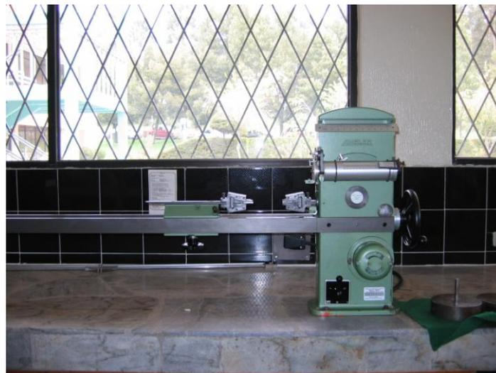
**Figura. 3.4 Máquina para el ensayo de materiales plásticos.**
