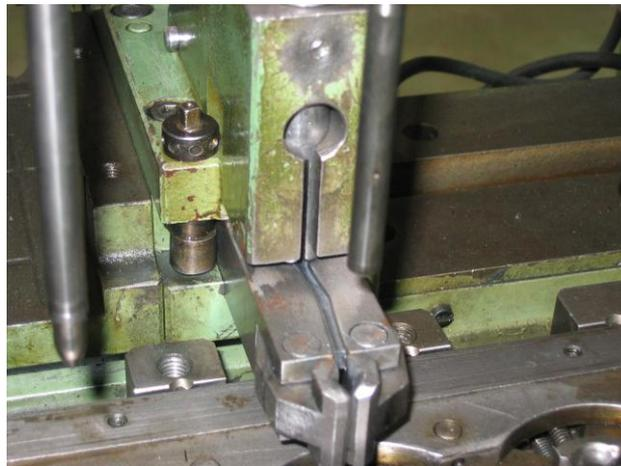
**Figura. 2.37 Mecanismo de ensamble copa bala – núcleo de plomo**
