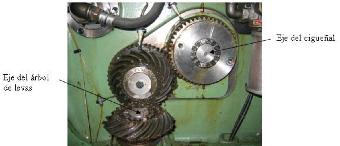
**Figura. 2.14 Relación entre el eje del cigüeñal y el eje del árbol de levas vertical**
