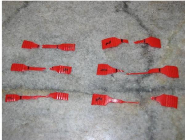
**Figura. 3.5 Probetas realizadas los ensayos de tracción**
