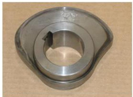
**Figura. 2.15 Levas (PB 31-10) que permiten el movimiento del transportador**
