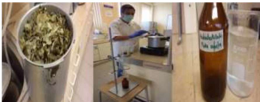
Figura 6. Proceso de obtención del hidrodestilado de Pin'ku ( Piper carpunya ).
