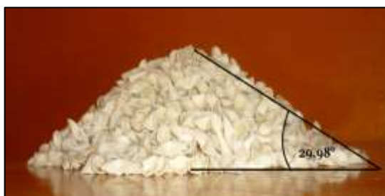
Figura 19. Angulo de talud de los fideos marca Sultanita
