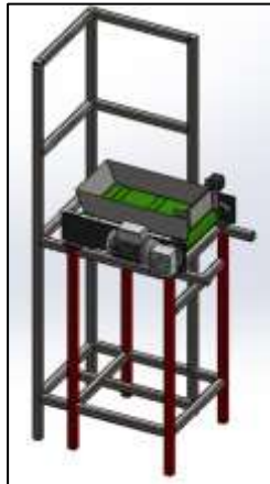
Figura 86. Columnas de la banda transportadora.
