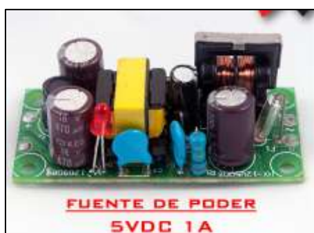
Figura 106. Fuente de voltaje 110VAC a 5VDC
