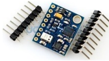
Figura 28: IMU / Modelo MPU - 6050. Fuente: [29]
