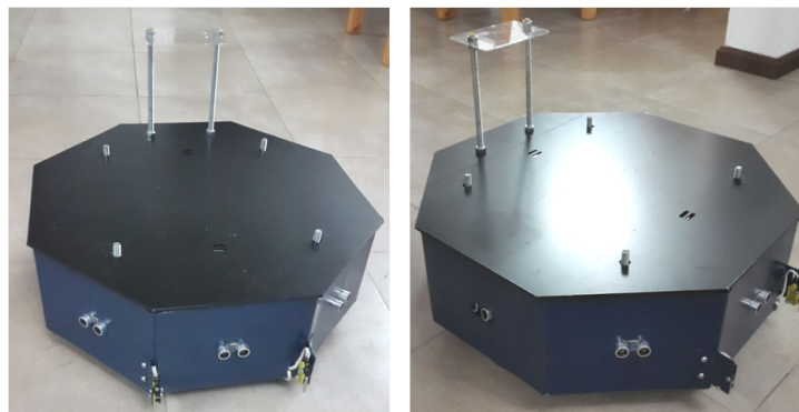
Figura 42: Instalación de soportes
