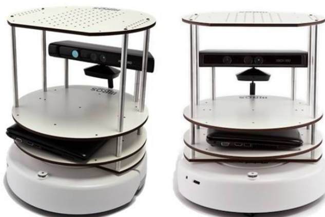
Figura 7: Plataforma robótica móvil TurtleBot Fuente: [Open Source Robotics Foundation, 2014]
