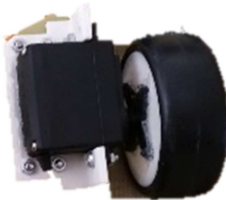
Figura 55. Acople de la llanta maestro con el servomotor
