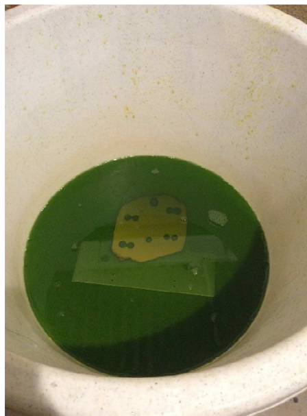
Figura 51. Chasis sumergido en agua con cloruro férrico
