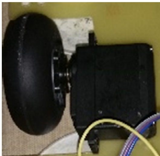
Figura 56. Acople de la llanta esclavo con el servomotor
