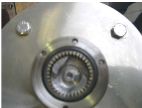
Figura 2.6 Detalle del rotor-estator del molino coloidal.
