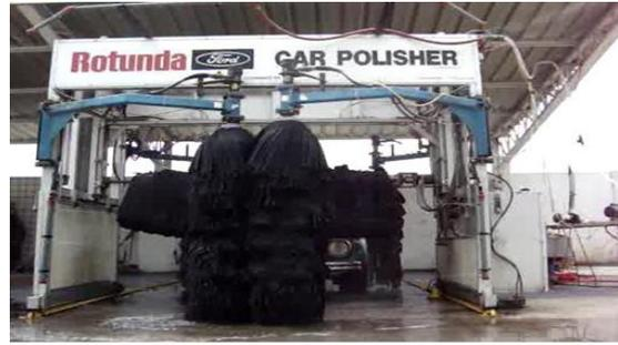
Fig. 6.3.10 Fin de ciclo del movimiento de la estructura y brazos giratorios horizontal y verticales
