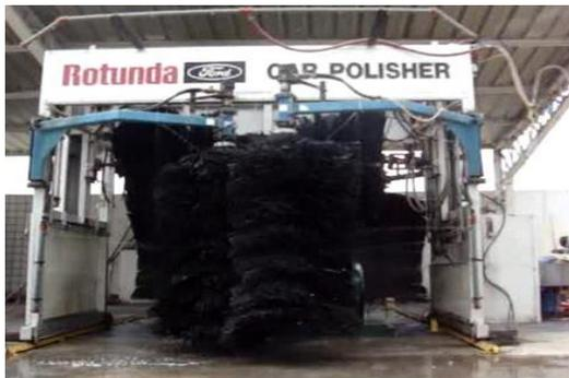
Fig. 6.3.3 Avance del carro del sistema hacia el fondo
