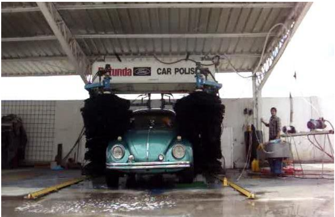
Fig. 6.3.6 Inicio del sentido de venida del movimiento de la estructura y brazos giratorios 191
