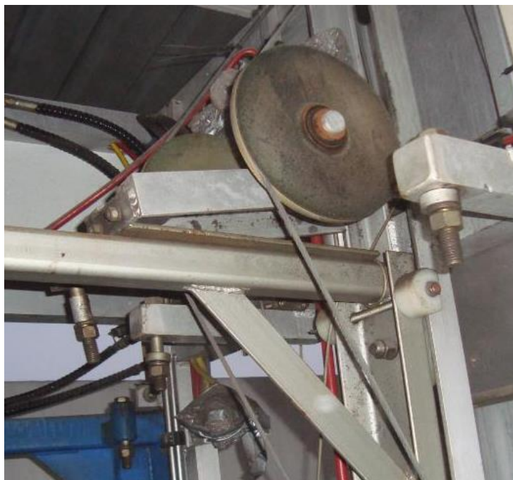
Fig. 3.1.1.3.1 Poleas del sistema car wash 66
