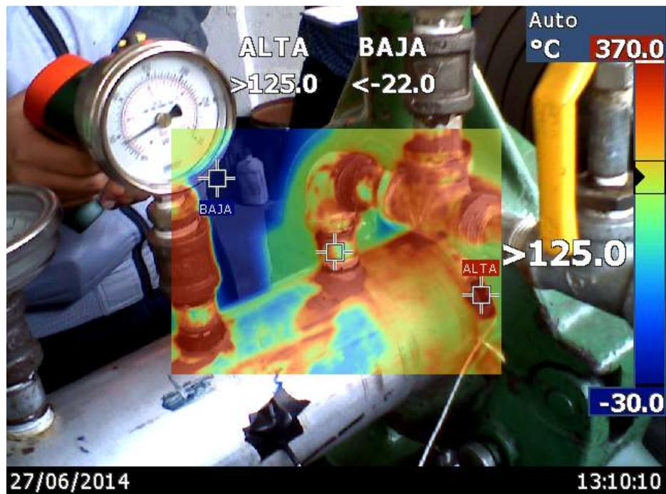
Temperatura en accesorios de la tubería galvanizada utilizada en el proceso de calentamiento de agua con el CVH.
