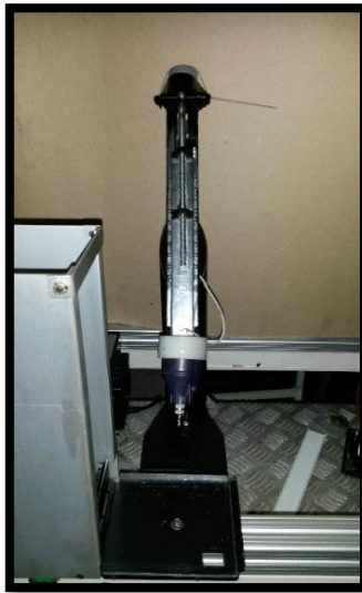
Figura 44 Taladro implementado en la estación.
