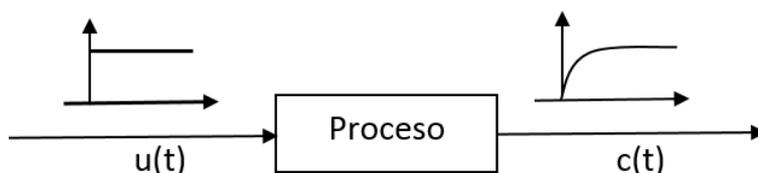
Figura 3.8: Respuesta escalón unitario del proceso o planta
