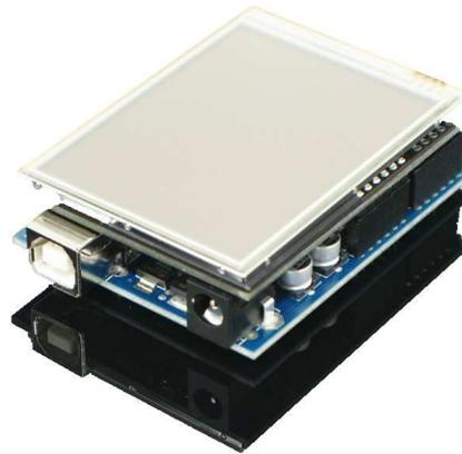
Figura 5.43: Módulo arduino tft -touch
