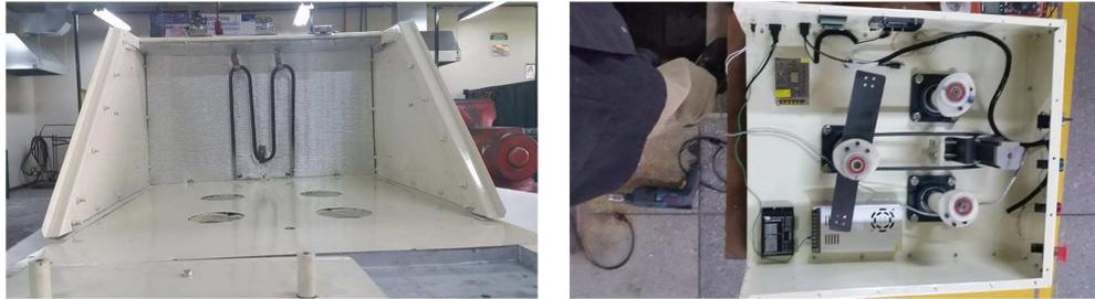
Figura 6.8: Instalación de los actuadores de la incubadora con agitación
