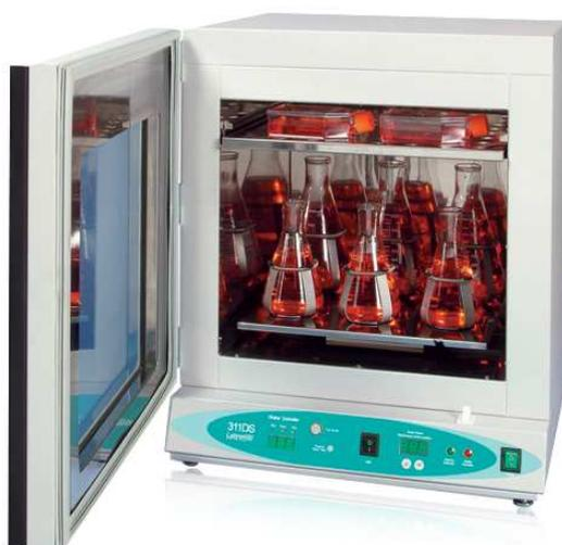
Figura 6.17: Incubadora con agitación existente en los laboratorios de biotecnología
