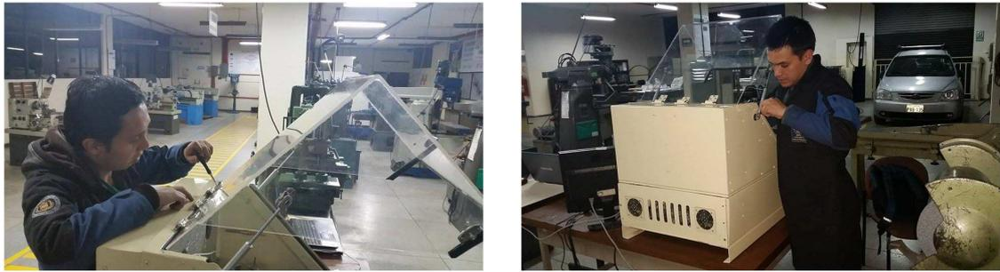
Figura 6.10: Instalación de la tapa de la cámara de incubación y sus componentes
