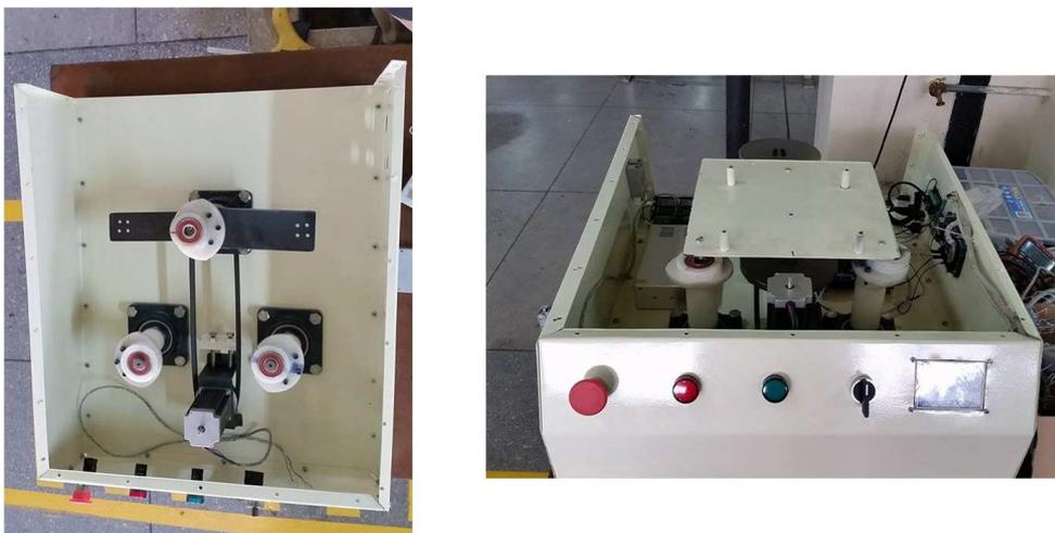
Figura 6.5: Ensamble de los componentes del mecanismo de agitación
