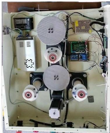
Figura 6.9: Conexión final de los componentes electrónicos
