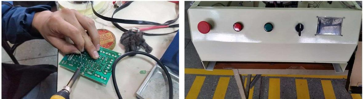
Figura 6.6: Soldadura de elementos electrónicos e instalación de componentes del panel de control
