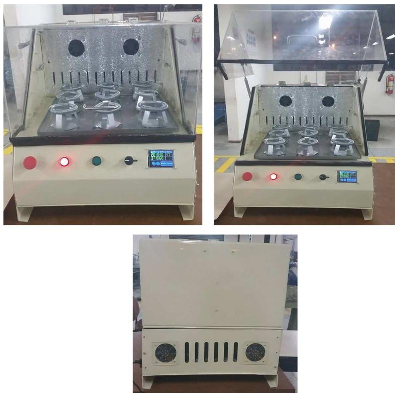
Figura 6.12: Prototipo finalizado de la incubadora con agitación
