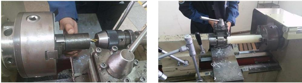
Figura 6.3: Construcción de los componentes de la felcha motriz y ejes de apoyo
