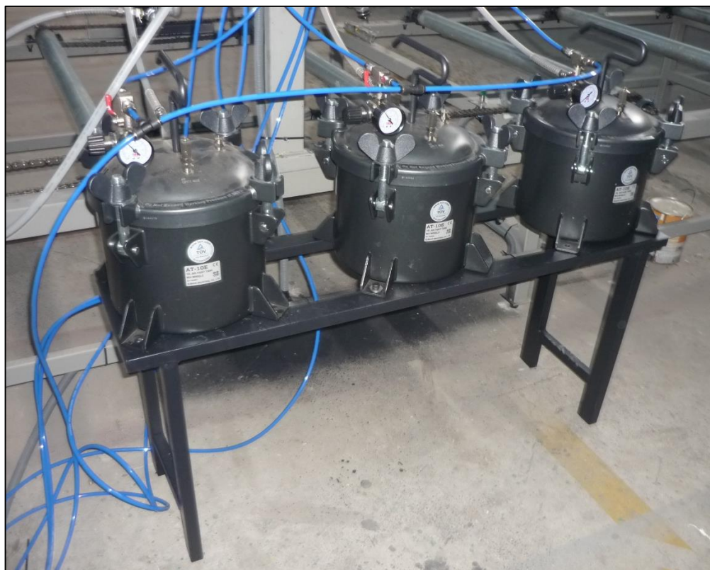
Figura No. 4.12: Montaje de los tanques de pintura
