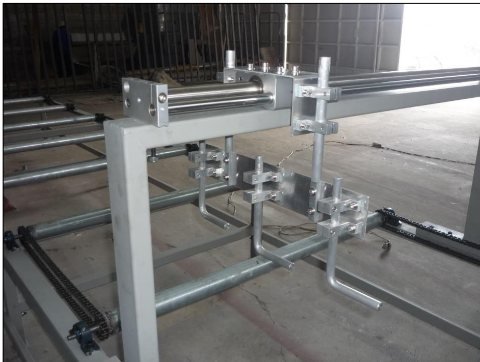
Figura No. 4.8: Montaje del Cabezal Porta-pistolas
