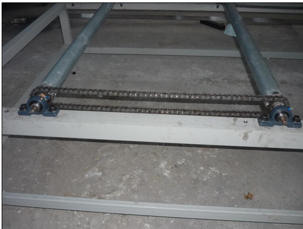
Figura No. 4.5: Montaje de los rodillos
