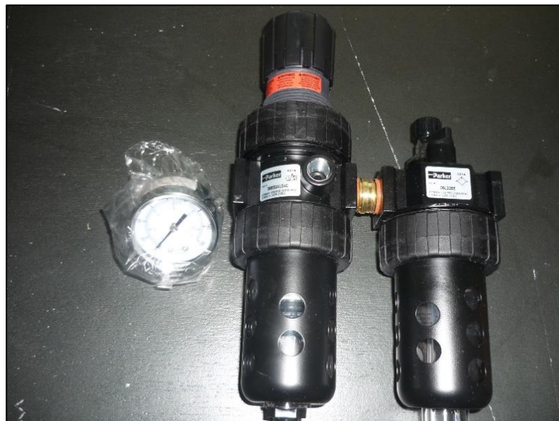
Figura No. 3.78: Filtro de aire y aceite/regulador Parker para las pistolas
