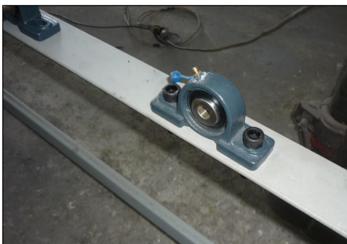
Figura No. 4.3: Montaje de las chumaceras
