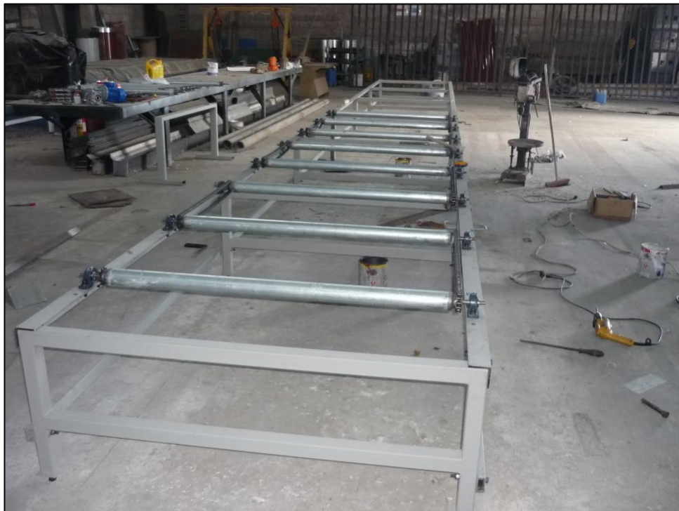
Figura No. 4.4: Montaje de los rodillos
