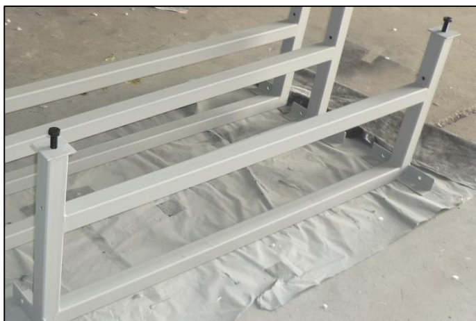
Figura No. 4.2: Apoyos regulables de la estructura
