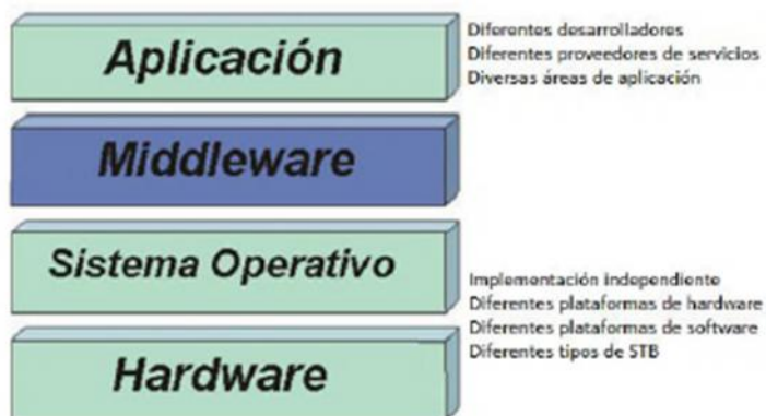
Figura 1. Estructura de un terminal de acceso
