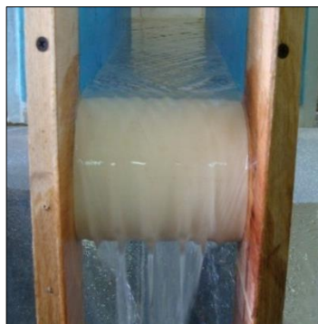
Figura 37.- Vista frontal del vertedero P=0, D1=81.7 mm.
