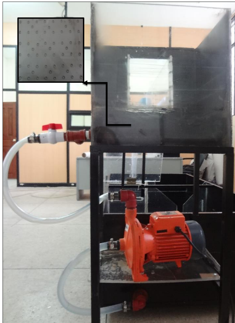
Figura 26.- Vista posterior del modelo (Tanque reservorio, conexión – bomba - tanque abastecimiento) y rejilla (recuadro).
