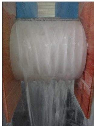
Figura 38.- Vista frontal del vertedero P=2R, D1=110 mm.
