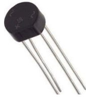
Figura 19. Puente de diodos
