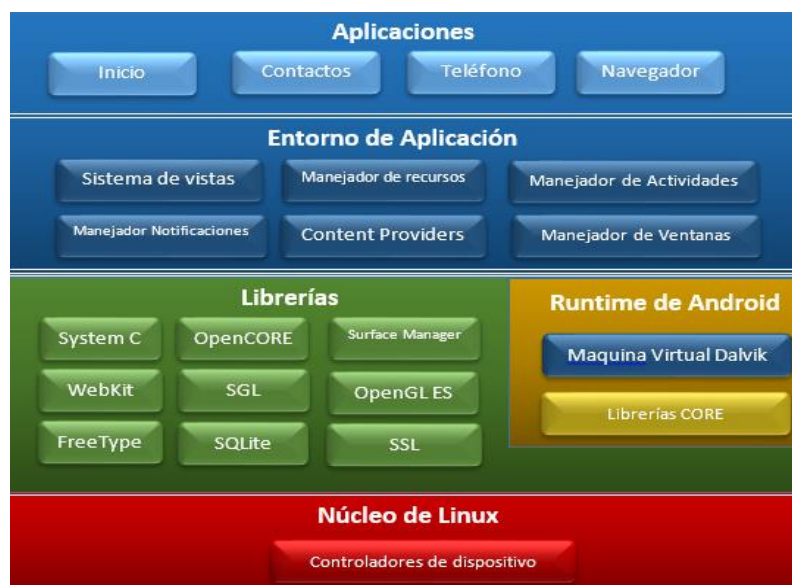
Figura 3. Arquitectura de Android.
