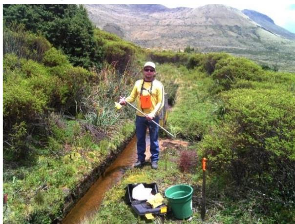
**Figura 9. Medición de Caudales**
