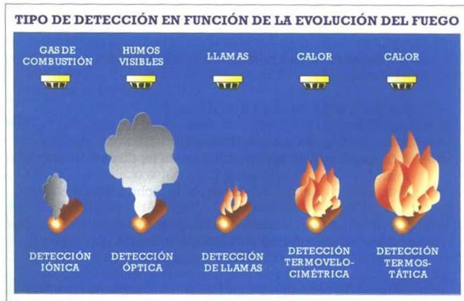
Figura 10: Tipo de detección de incendios Fuente: (Suinca, 2010)
