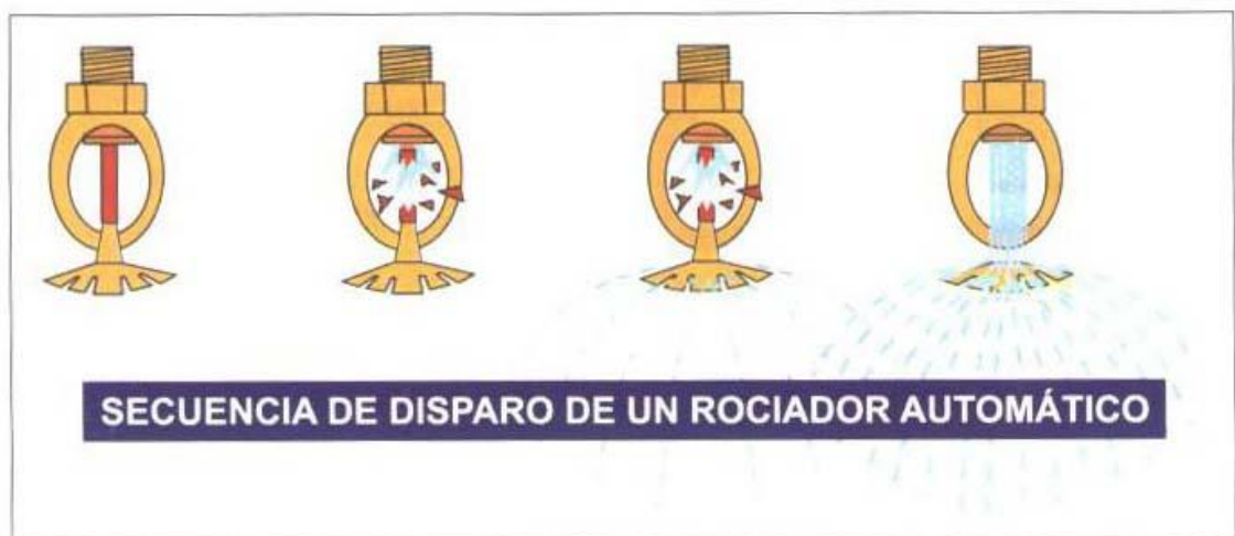
Figura 13: Secuencia de disparo rociadores automáticos SCI Fuente: (Suinca, 2010)
