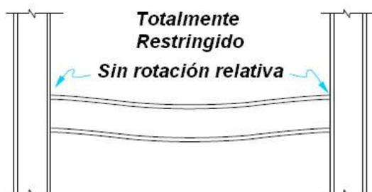
Figura 2. 2. Conexiones rígidas
