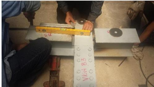
Figura 5. 13. Escuadrado y nivelado de la viga B3
