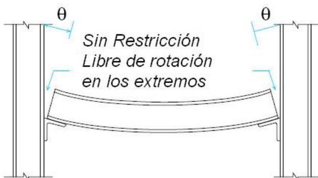
Figura 2. 1 Conexiones simples
