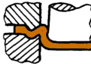
Fig. 5: Ejemplo de Prensachapas de presión y de freno.
