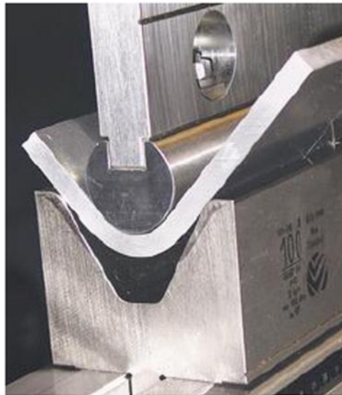
Fig. 1: Ejemplo de la operación doblado
