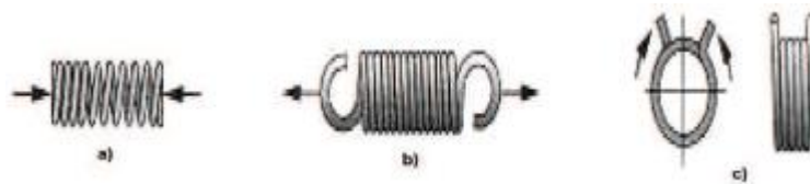
Fig. 7: Tipos de resortes: a) Compresión, b) Tracción, c) Torsión.
