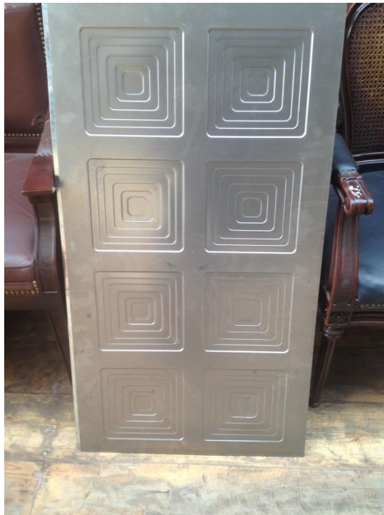
Fig. 49: Resultado lámina metálica cuarta prueba
