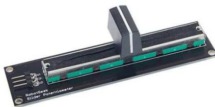
**Figura 162. Potenciómetro lineal.**
