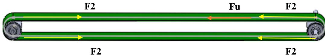
**Figura 96. Tensiones en la Banda de Fotos.**
