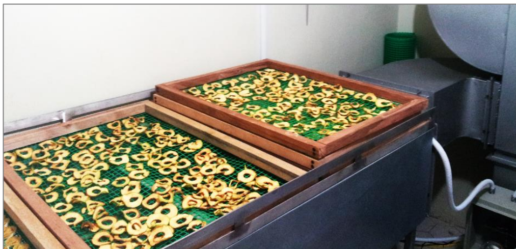
Figura 6. Proceso de deshidratación por aire forzado caliente
