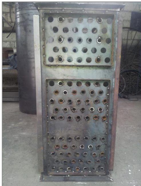
Figura 101. Punteo y alineación de tubos antes de la suelda Fuente: (Guasumba, J., Biocalefón, 2003 - 2008)
