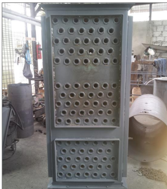
Figura 102. Intercambiador de calor después de suelda hermética de tubos Fuente: (Guasumba, J., Biocalción, 2003 - 2008)
