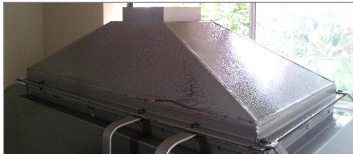
Figura 105. Campana de extracción de gases
