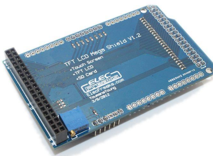
Figura 4.24 Módulo reductor de voltaje para la pantalla
