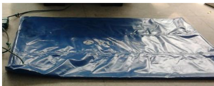
Figura 4.9 Gasómetro de polietileno
