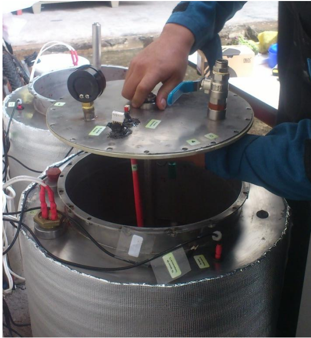
Figura 6.7 Montaje final de la tapa, empaque, en el digestor cargado
