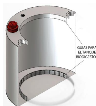
Figura 4.4 Cámara de Agua o Sistema de Calentamiento
