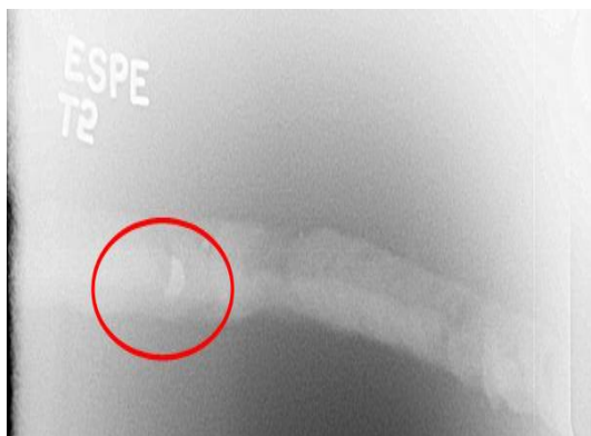
Figura 61 Quemón en la soldadura
