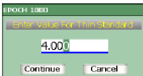
Figura 78 Segundo valor de referencia del patrón de calibración
