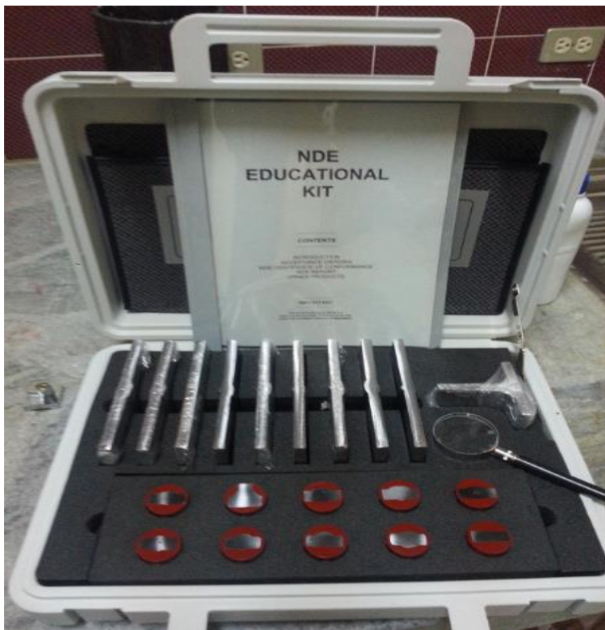
Figura 66 Probetas certificadas con defectos conocidos
