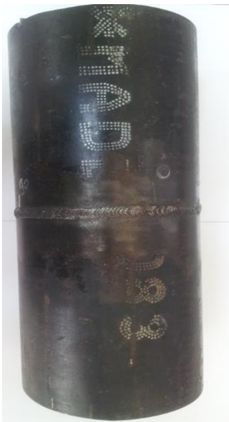
Figura 60 Probeta de tubería
