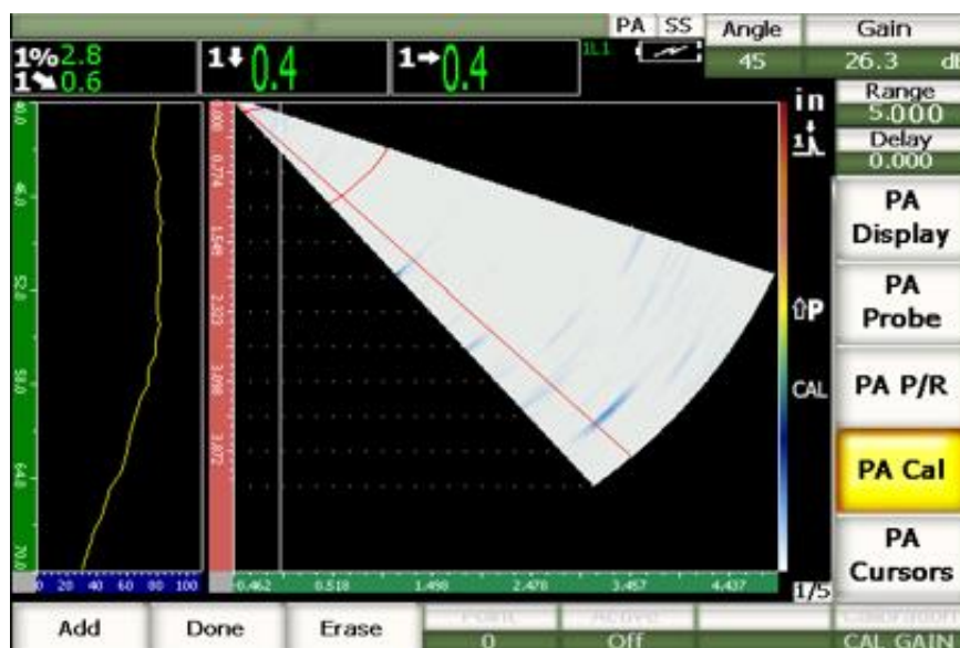
Figura 86 Calibración de la línea de ganancia
