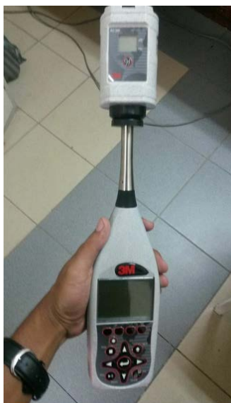
Figura 51: Calibración del sonómetro SoundPro SE-2
