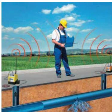
*Figura 8. Equipo de detección de fugas - Correlador*
