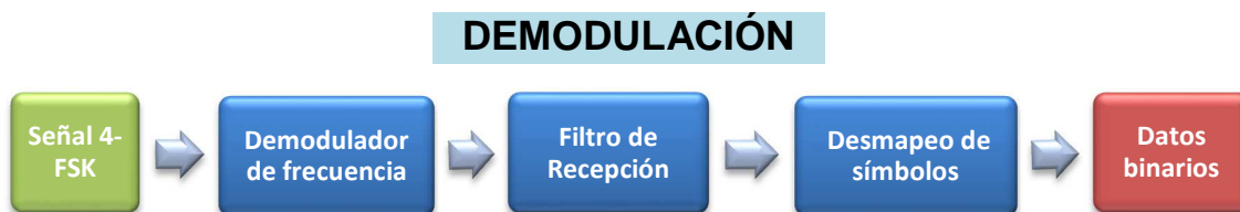
Figura 13. Demodulación de NXDN™ Fuente: (NXDN Forum Website, 2014)
