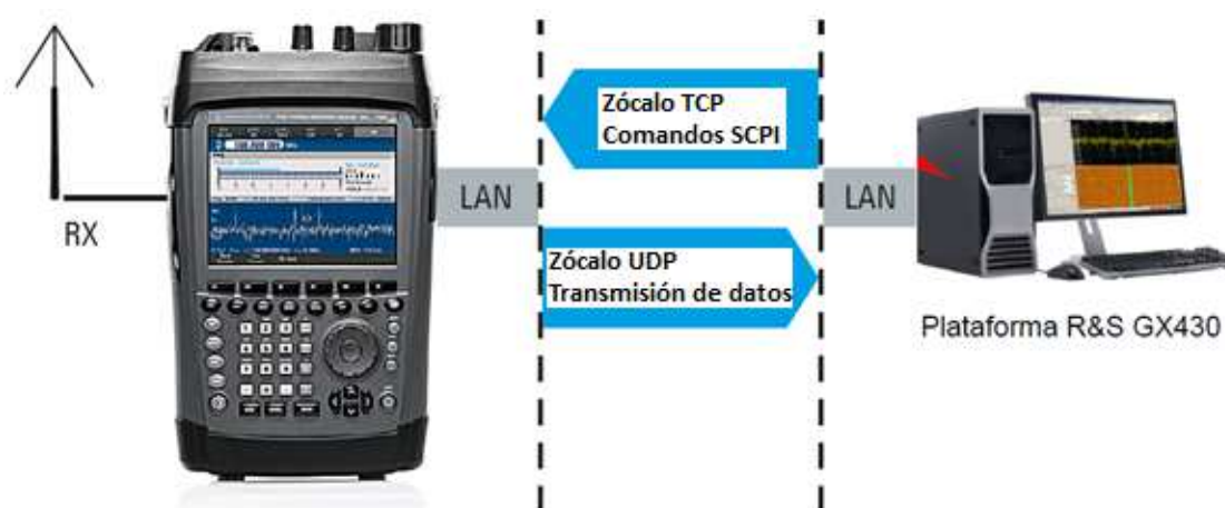
Figura 9. Comunicación entre el R&S®PR100-RC y el software R&S®GX430 Fuente: (Rhode&Schwarz, 2014)
