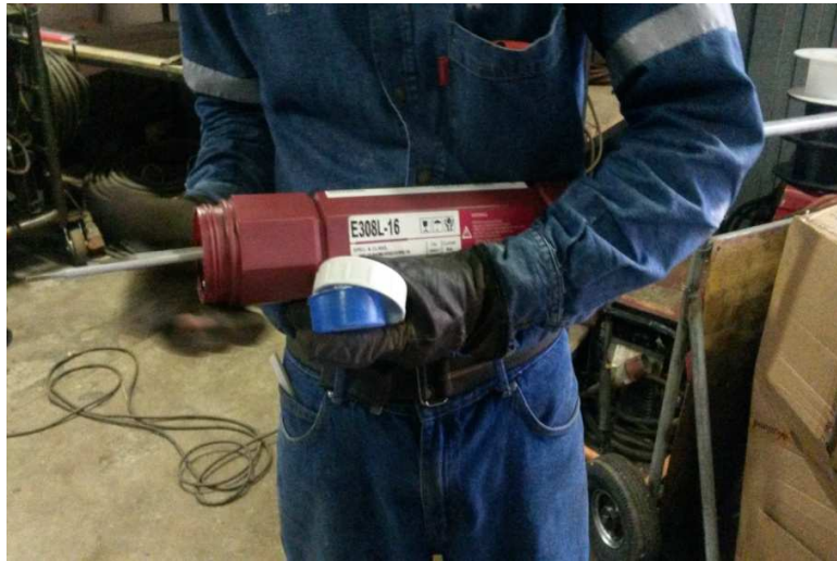
Figura 73. Colocación de Consumibles en Termos
