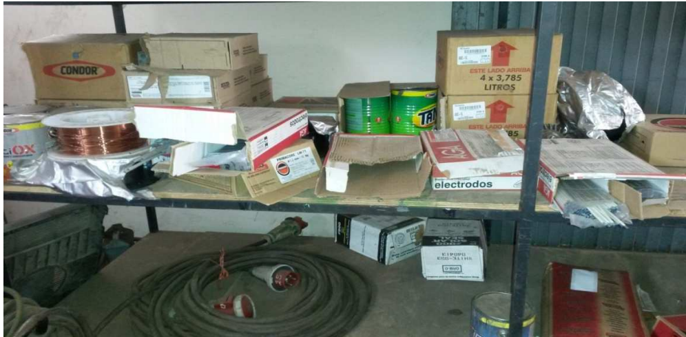
Figura 22. Almacenamiento Inadecuado de Consumibles
