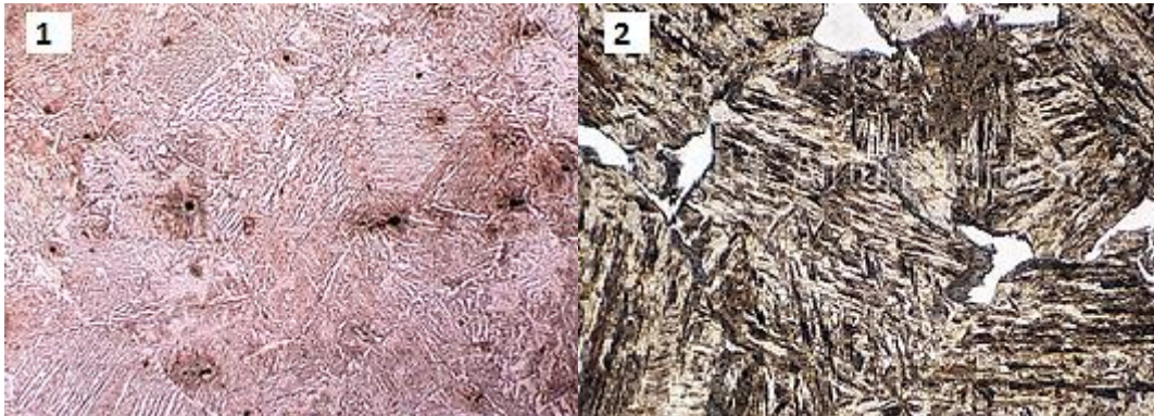
Figura. No. 89. Perlita fina hallada en la parte superior de la junta, entre el material de aporte y el límite de fusión. Acero ASTM A588 / 12 mm y 20 mm. 2. Metalografía de Perlita gruesa
