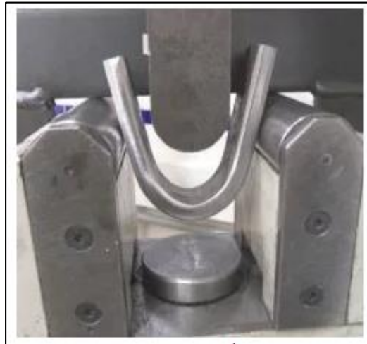
Figura. No. 7. Probeta ensayada para doblado. Fuente: (Ecured.)
