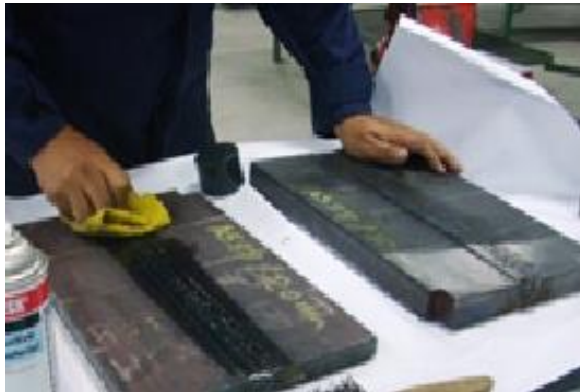
Figura. No. 46. Limpieza de cupones de soldadura.
