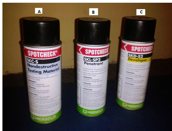
Figura. No. 45. Kit de tintas penetrantes. A. Limpiador B. Penetrante C. Revelador.
