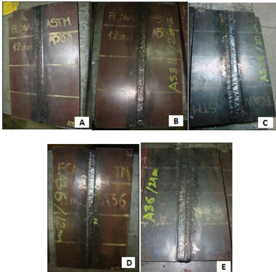
Figura. No. 44. Cupones de soldadura para inspección visual A,B,C Acero ASTM A588 12, 20 y 30 mm de espesor respectivamente, D y E Acero ASTM A36, 12 y 24 mm.
