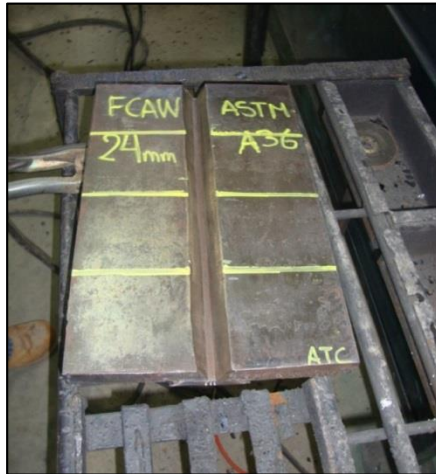
Figura. No. 39. Control de tiempos de soldados con marcas transversales en cupón.
