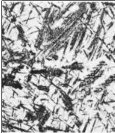
Figura. No. 25. Agujas oscuras de bainita inferior en matriz de martensita (500x) Fuente. (Larre, 2013)
