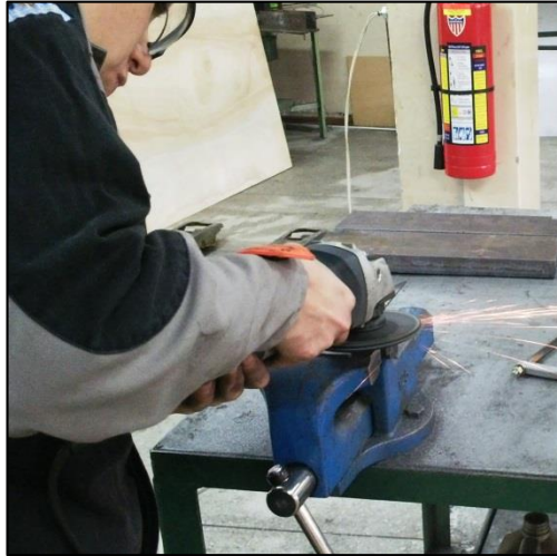
Figura. No. 52. Rebajada de sobre - monta a probetas.
