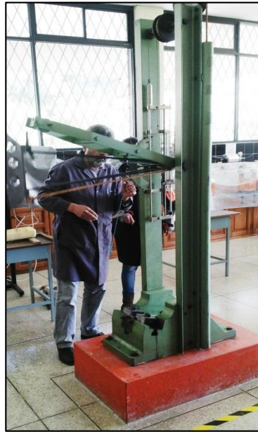
Figura. No. 56. Caída del péndulo para golpear a la probeta.
