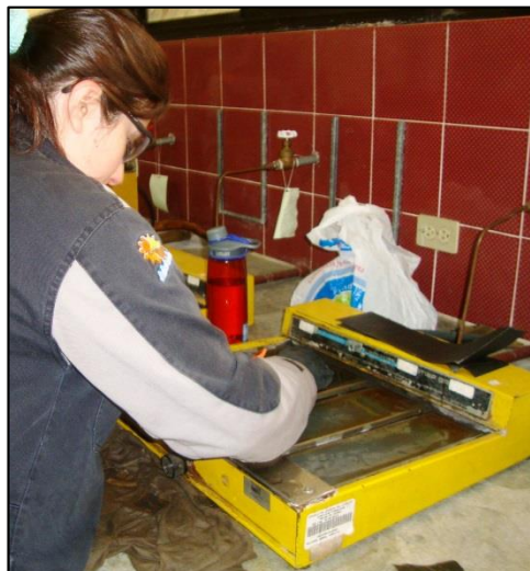
Figura. No. 58. Lijado manual de probetas para metalografía.
