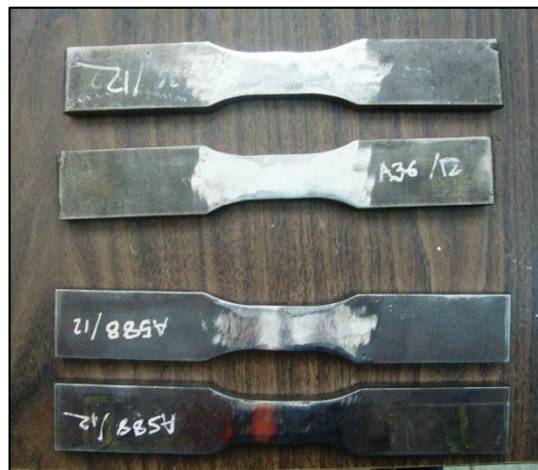
Figura. No. 55. Probetas antes de ser sometidas a ensayo de tracción.
