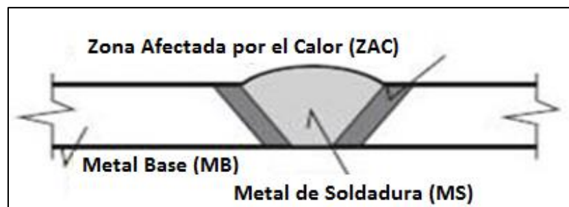
Figura. No. 13. Zonas formadas por la soldadura. Fuente: (Monografias.com)
