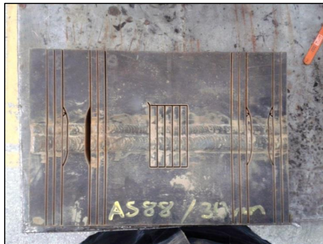
Figura. No. 51. Cupón de soldadura una vez realizado los cortes.
