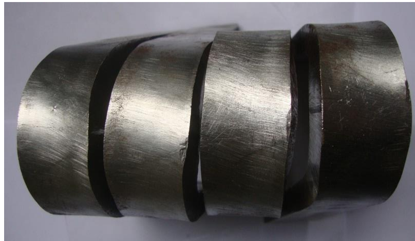
Figura. No. 72. Ensayos de doblado lateral, acero ASTM A36, 24 milímetros. Vista frontal.
