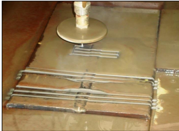
Figura. No. 50. Corte de cupón de soldadura mediante chorro de agua.
