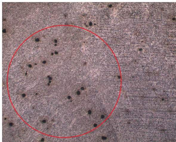
Figura. No. 90. Inclusiones de SiO 2 en probetas de acero A588 /12mm, 20mm y 30 mm.
