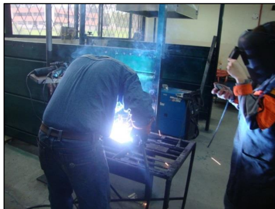
Figura. No. 41. Medición del tiempo de ejecución de cada cordón de soldadura.
