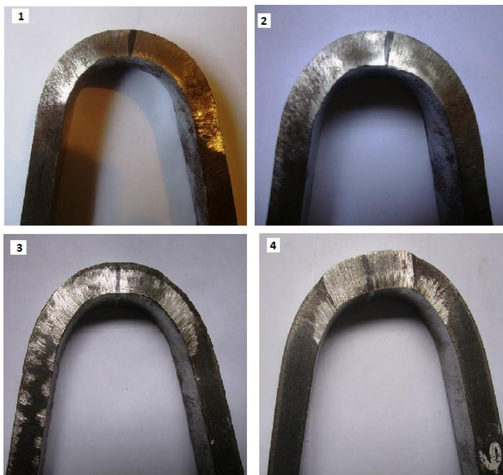
Figura. No. 69. Ensayos de doblado lateral, acero ASTM A36, 12 milímetros. Vista lateral.
