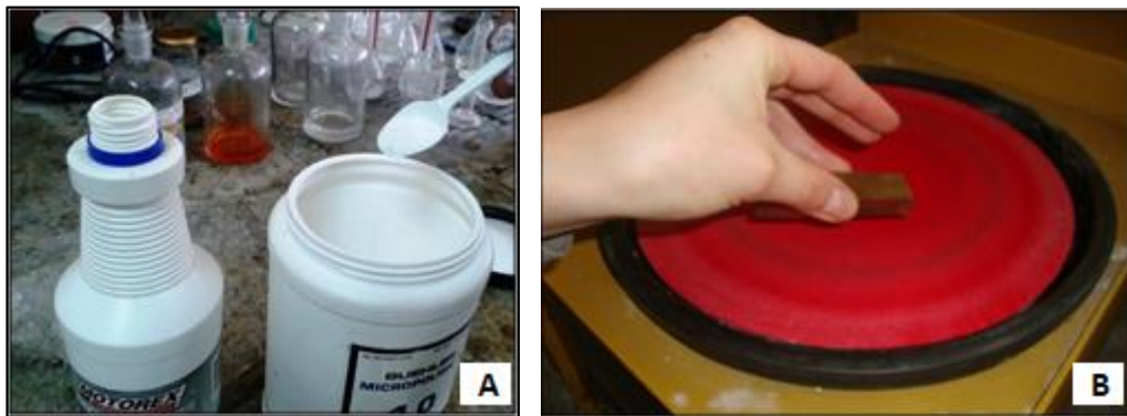
Figura. No. 59. A. Preparación de Alúmina. B Pulido fino de probetas.
