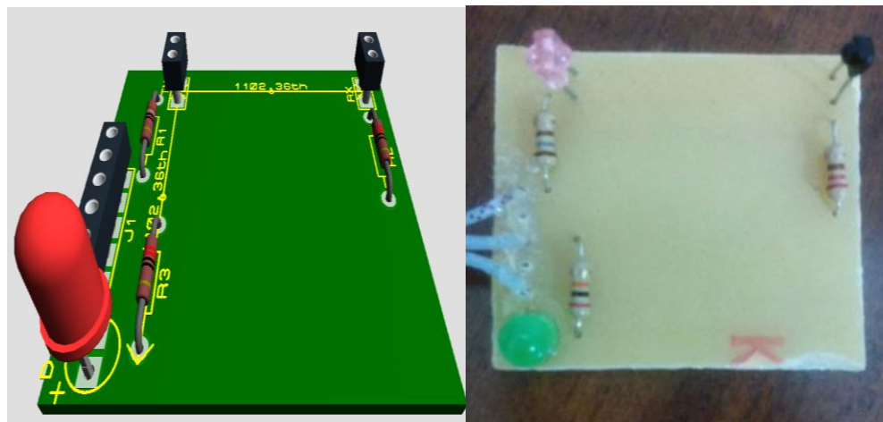
Figura 32. Diseño del circuito ya implementado
