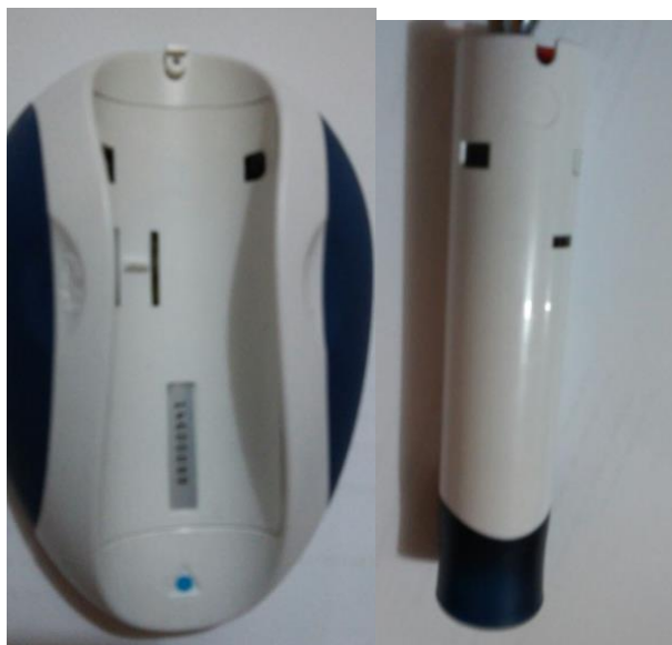
Figura 28. Orificios para los sensores
