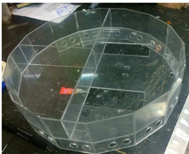
**Figura 3. 48 Base para Motores.**
