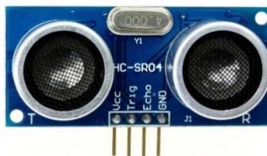
**Figura 3. 12 Sensor Ultrasónico HC-SR04 para Arduino.**
