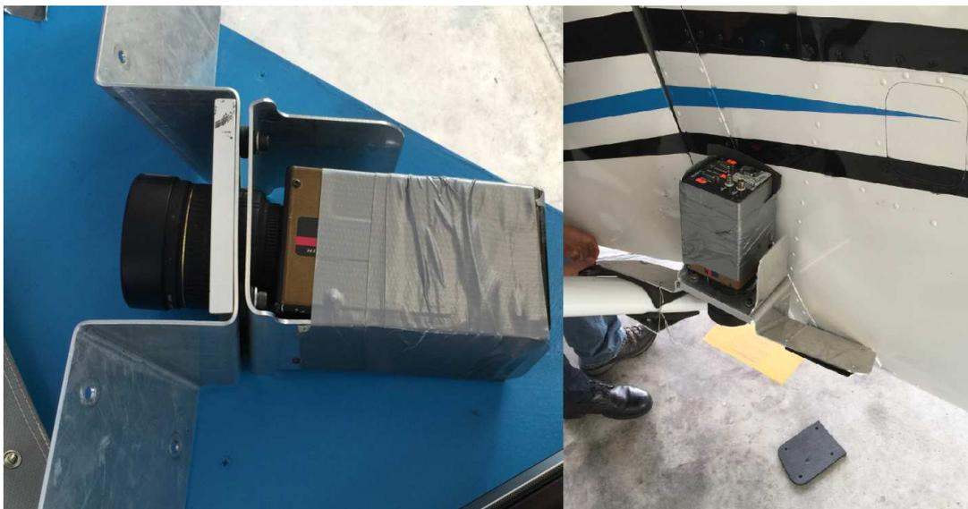
Figura 50. Montaje de cámara multispectral DuncanTech MS-4100
