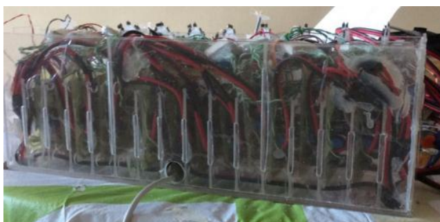
Figura 64 Distribución de los módulos A4988
