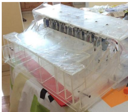
Figura 61 Estructura teclado y línea Braille
