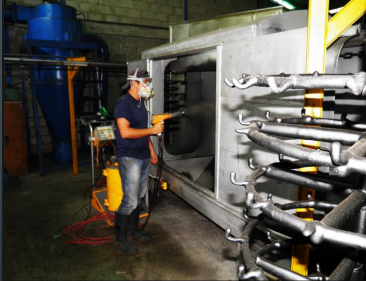
Vista de la ejecución de un pintado con pintura electrostática
