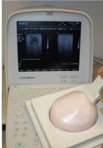
**Figura 39: Equipo para obtener una imagen por ultrasonidos 2D**
