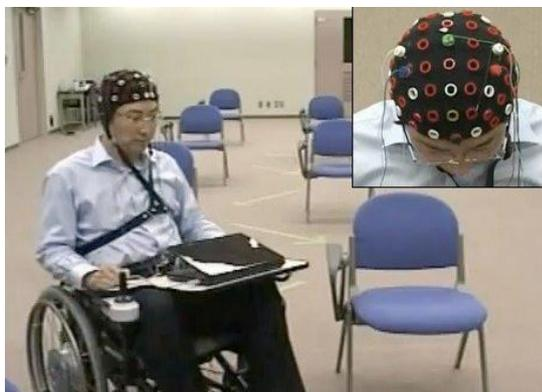
**Figura 25: Silla de ruedas controlada mediante ondas cerebrales.**
