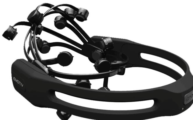
**Figura 82: Sensor de ondas cerebrales EMOTIV EPOC**
