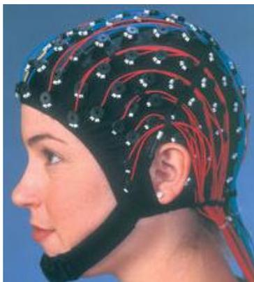
**Figura 42: Electrodo en casco de malla**
