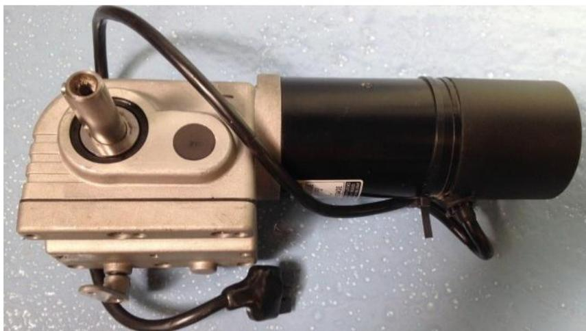
**Figura 78: Motor seleccionado para la silla de ruedas de este proyecto**
