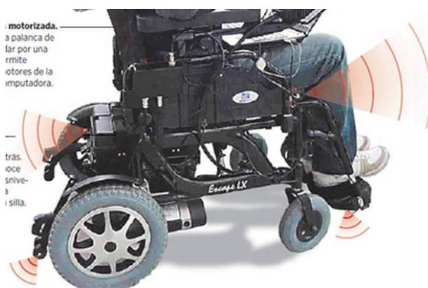
**Figura 24: Silla de ruedas con sensores de presencia**
