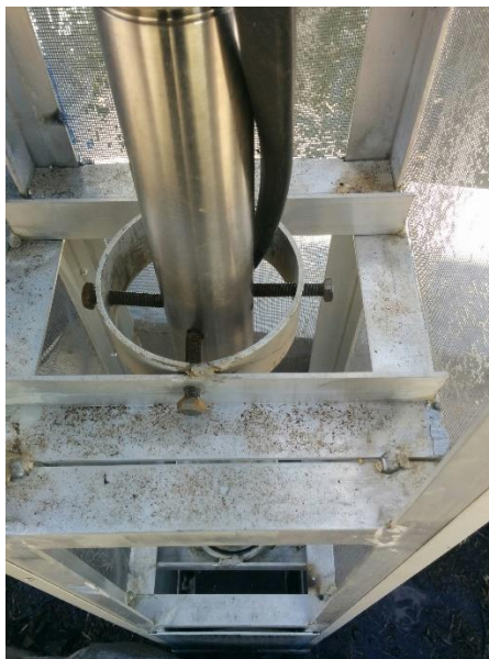
Figura 73 Sujeción de la bomba en la jaula.
