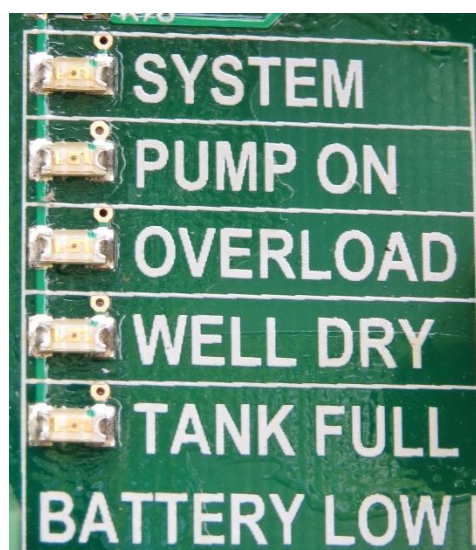
Figura 81 Luces indicadoras del estado de los sensores.
