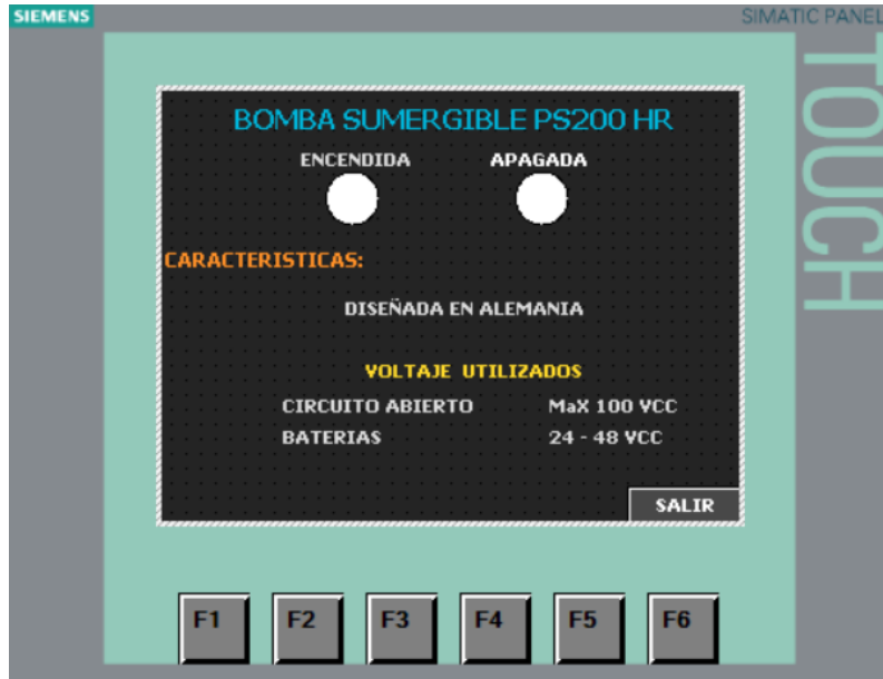
Figura 99 Ventana de información de la bomba PS200HR.
