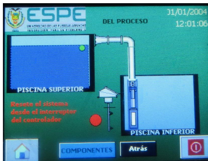
Figura 115 Acción de tanque lleno.
