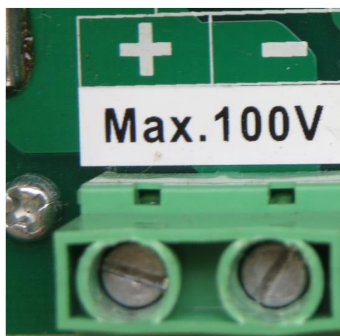
Figura 85 Puertos de voltaje principal.
