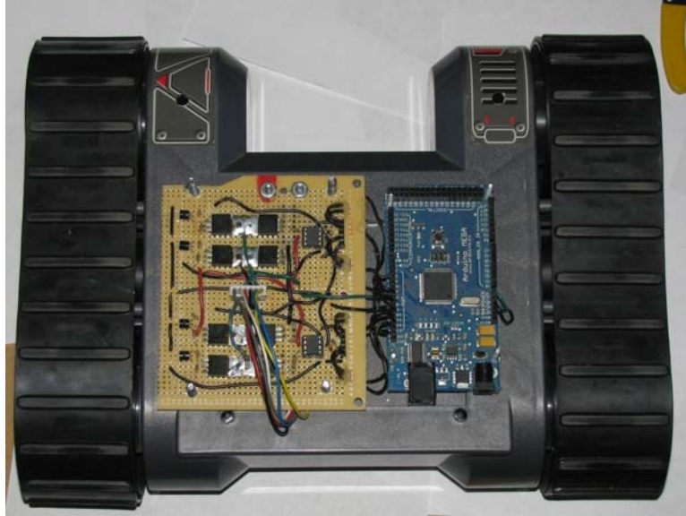
Figura 6. Tarjeta Arduino MEGA utilizada en un robot para navegación autónoma.
